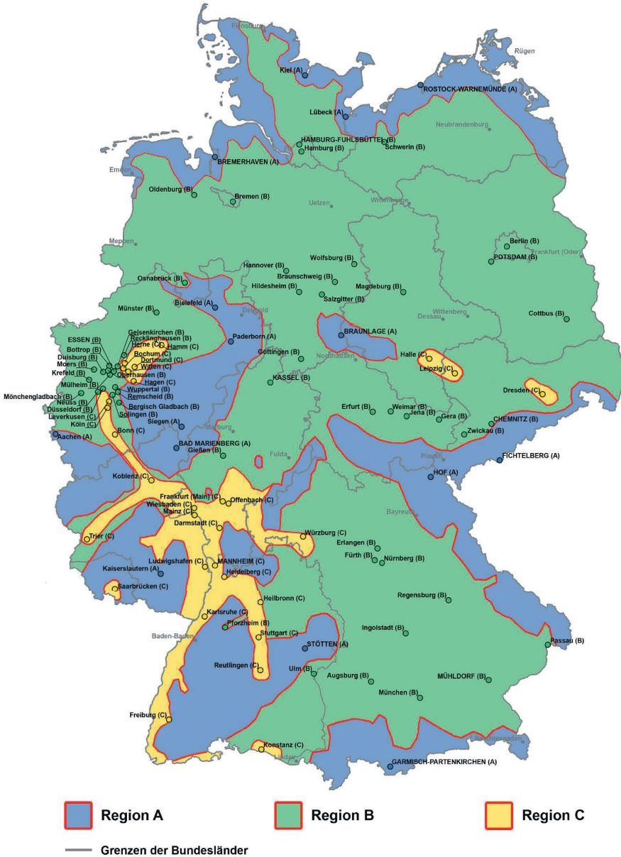
Bild 1: Zuordnung der Klimaregionen nach Abschnitt 8.1 der DIN 4108-2:2013
